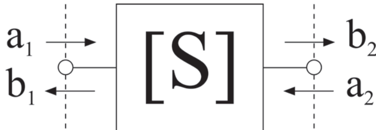
Abbildung 2.14: Zweitor mit ein- und auslaufenden Wellen [35]
