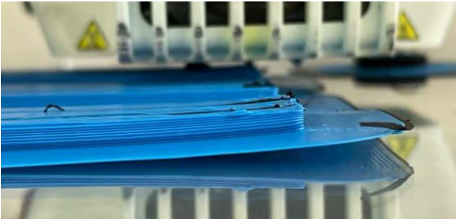
Abbildung 4.7: Adhäsionsproblem Add:North und Warping des ASA-Werkstoffs
