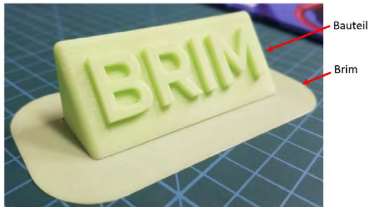
Abbildung 2.5: Brim beim 3D-Druck [16]
